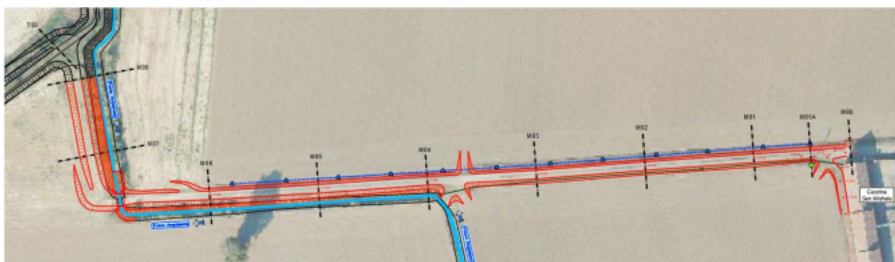
FIGURA 5-15 ESTRATTO DELLA PLANIMETRIA DI PROGETTO DELL'INTERVENTO N°2 TRA LE SEZIONI M00 ED M08
